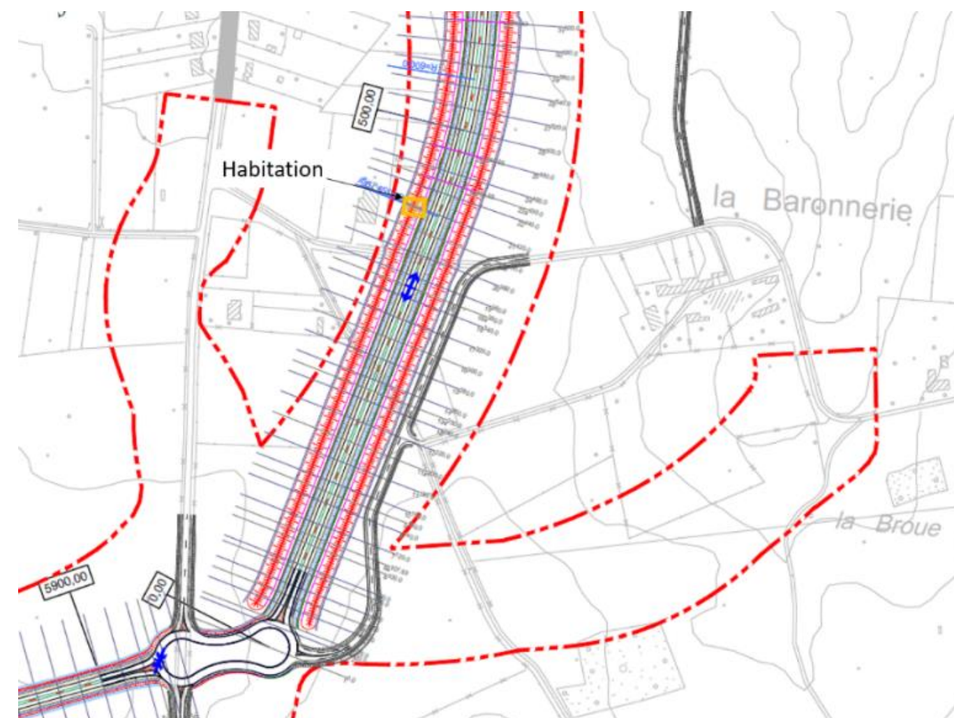
Évolution du projet et de ses incidences avec le bâti existant (orange) pour le projet optimisé
