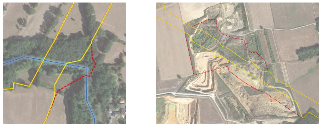
Zones d'optimisation des emprises chantiers ; à gauche : Ruisseau des Ages ; à droite : Carrière de Mazerolles. Le trait jaune représente l'emprise travaux actuelle, le rouge pointillé l'emprise travaux avant optimisation
