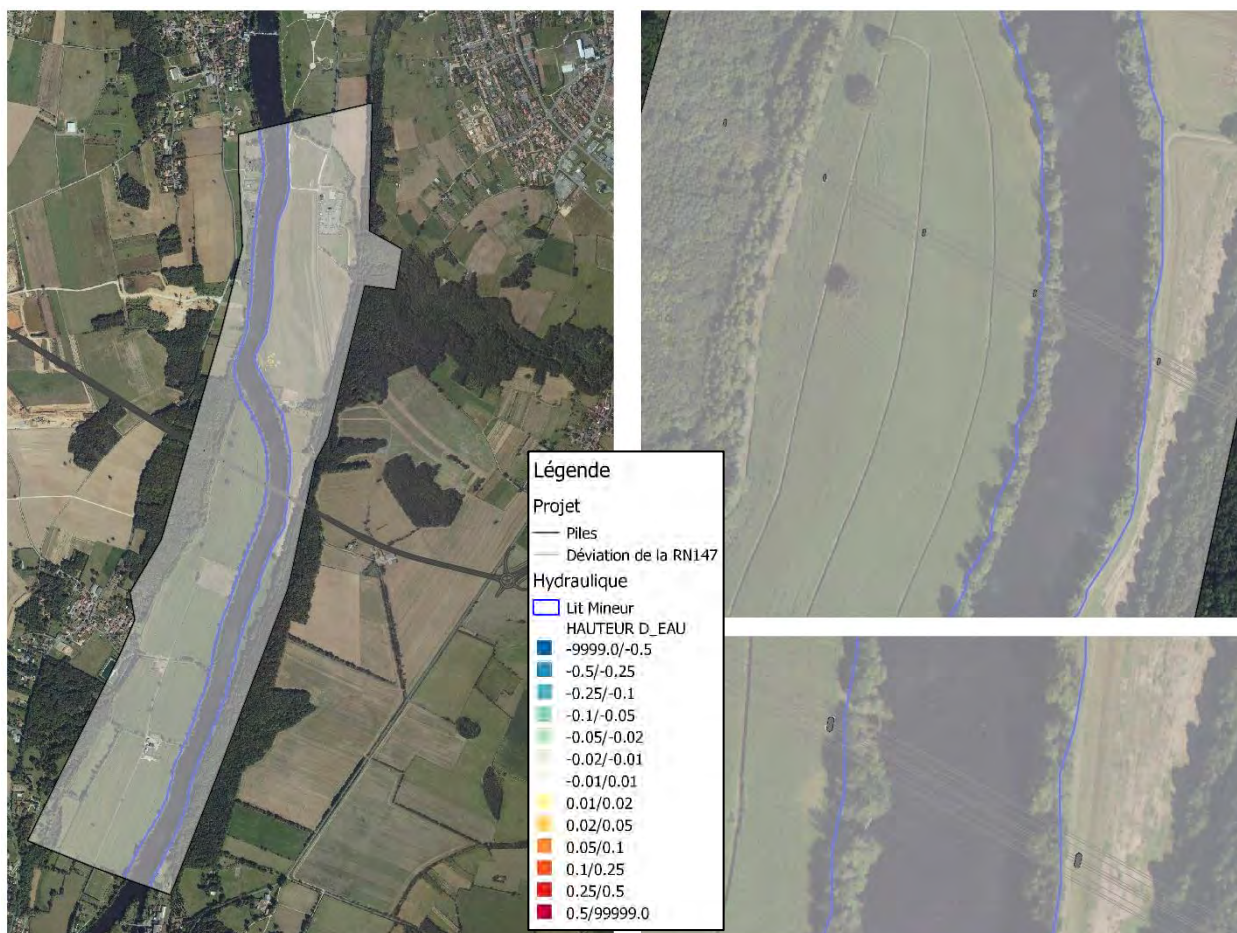
Figure 14 : Incidences de l'ouvrage de franchissement sur les niveaux d'eau - crue décennale (différence de hauteurs d'eau exprimée en m)
