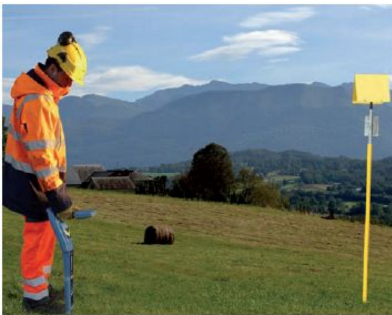
Détection d'une canalisation à l'aide d'un détecteur de conduite.
