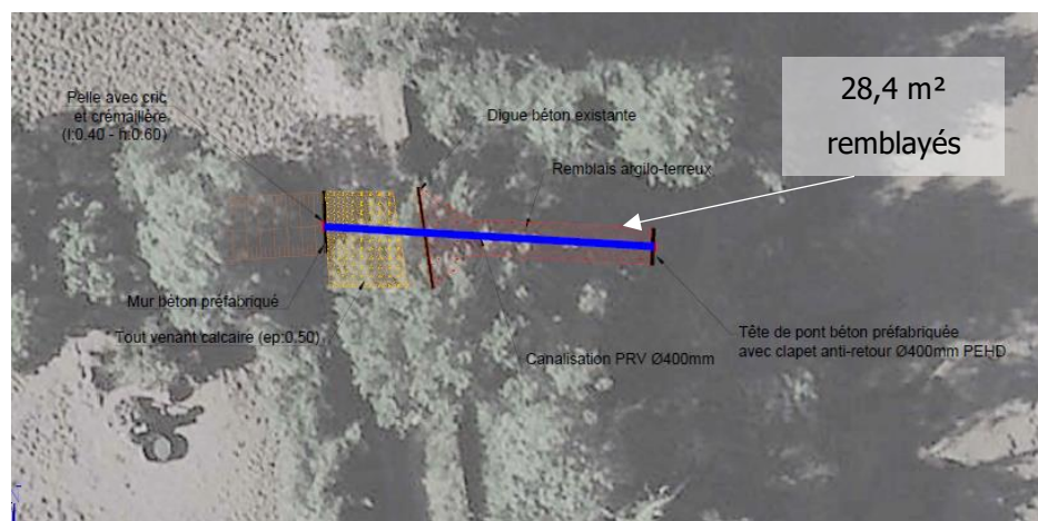
Figure 39. Plan des travaux au lieu-dit Pey
