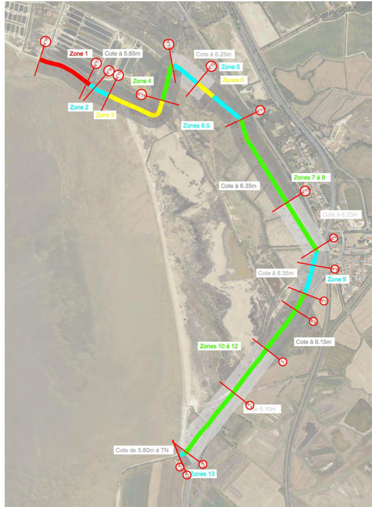
Figure 23 : plan de sectorisation de la digue et côtes d'arasés théoriques (en mNGF)
