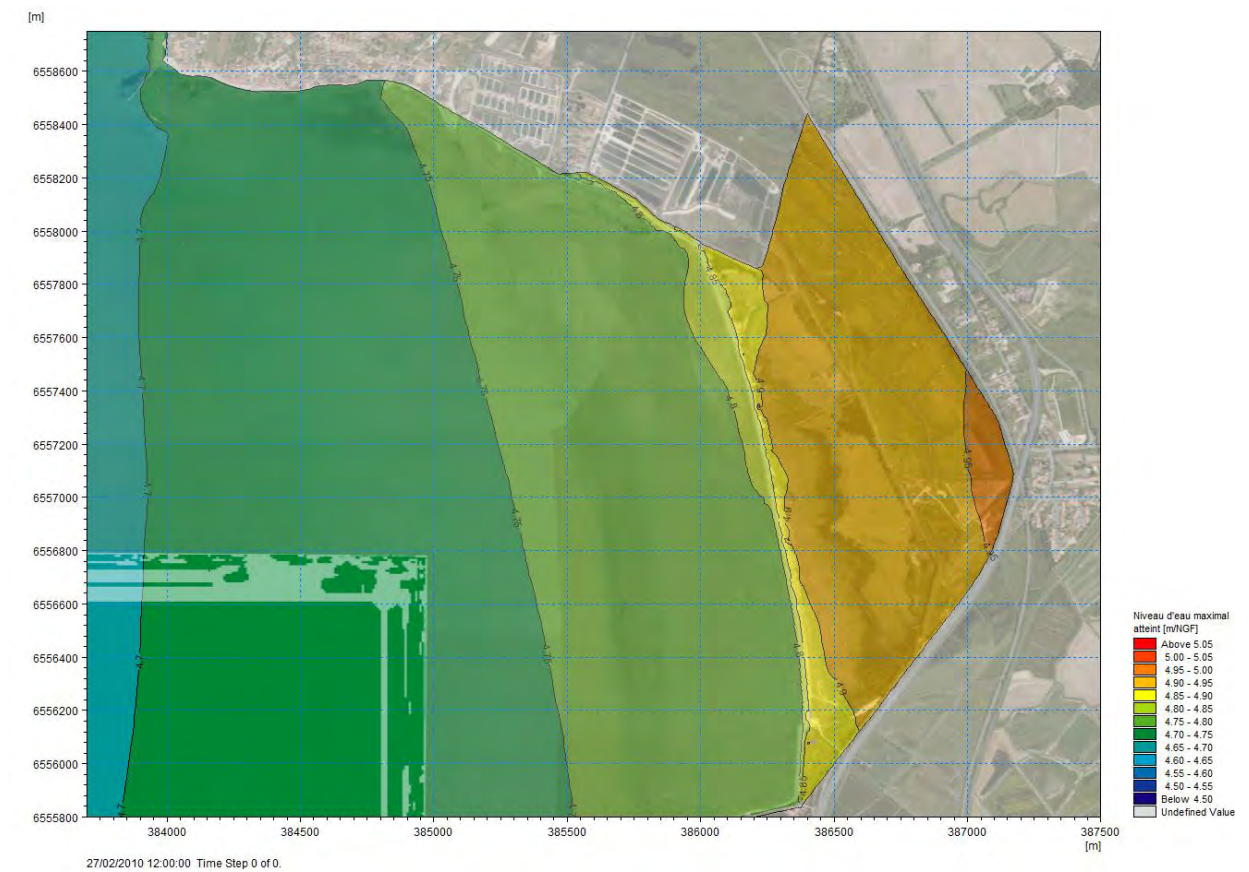
Figure 7 : niveaux d'eau maximums (hypothèse d'une brèche de 100 m dans le cordon dunaire protégeant la RNN)
