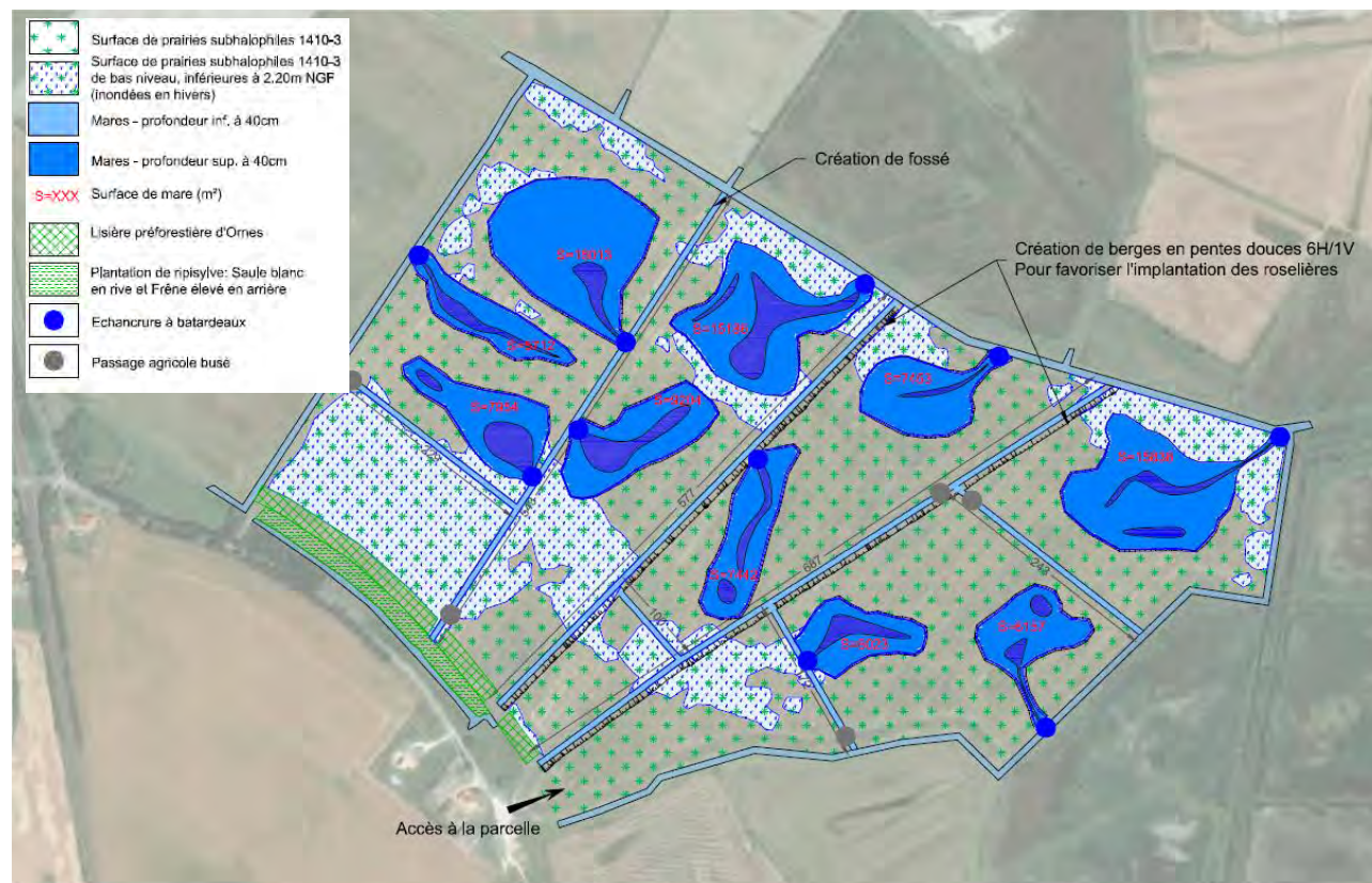
Plan d'aménagement de la zone d'emprunt à l'issue des travaux d'extraction
