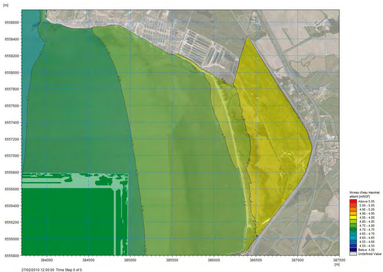
Figure 45 : niveaux d'eau maximums avec une arase à 3 mNGF du cordon dunaire
