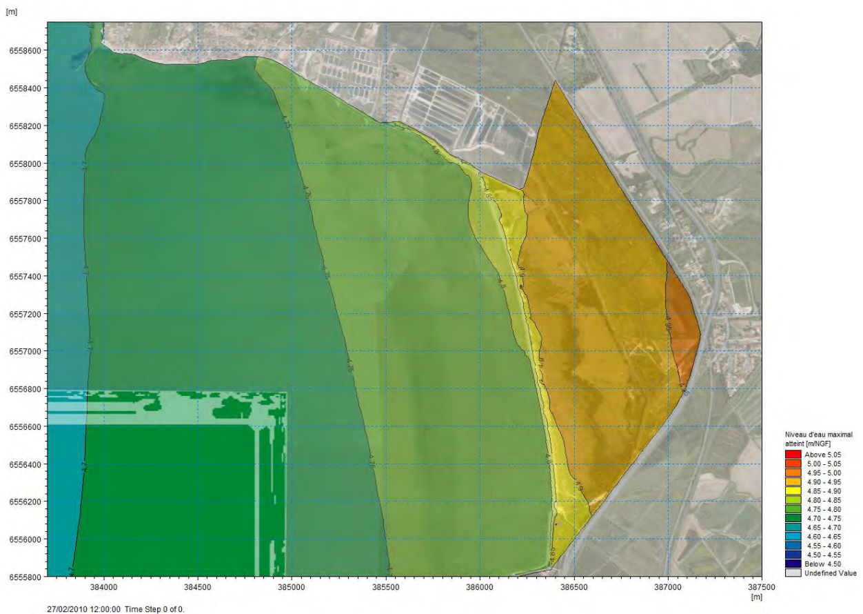
Figure 44 : niveaux d'eau maximums avec une brèche de 100 m dans le cordon dunaire
