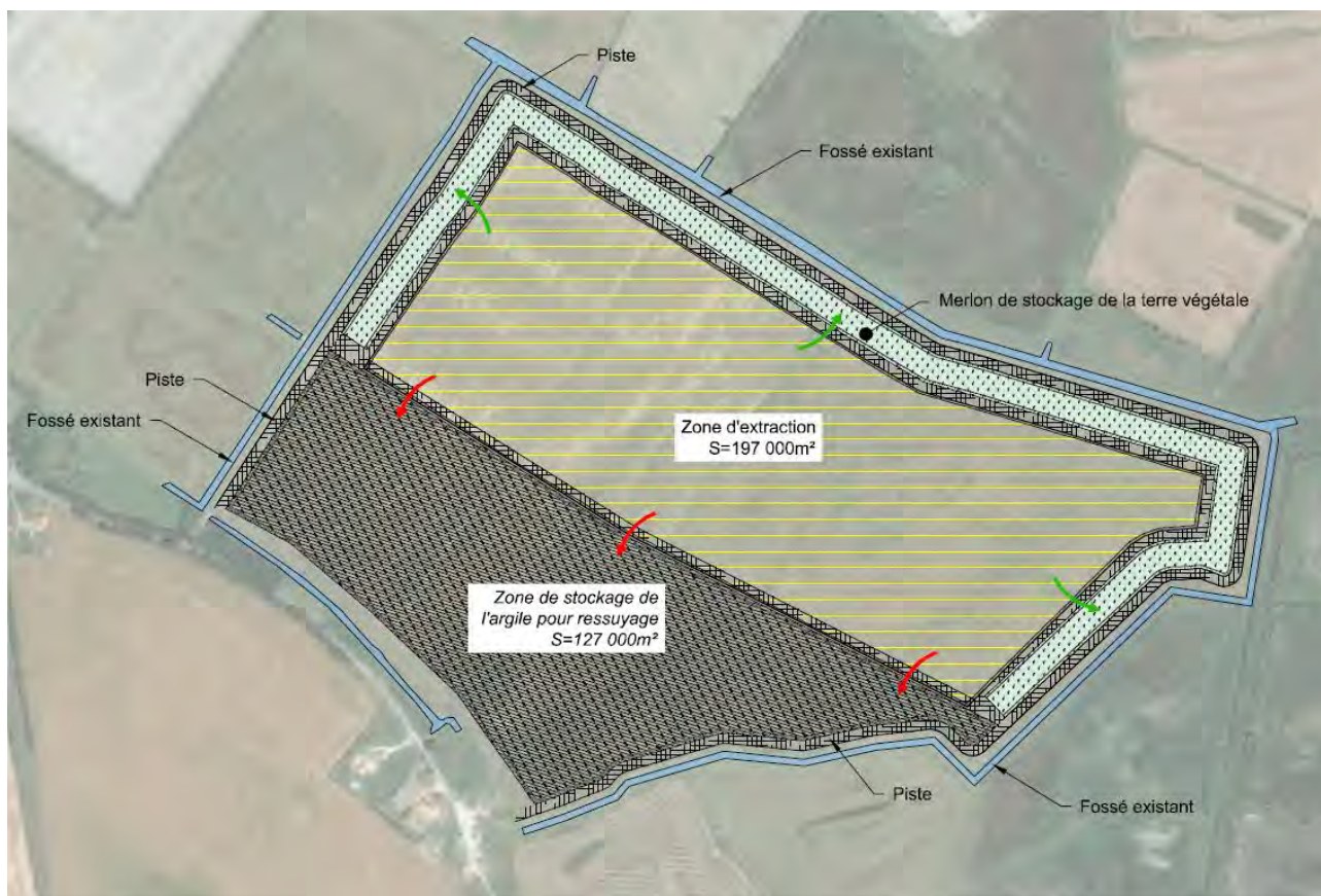
Figure 73 : Plan de terrassement de la zone d'emprunt
