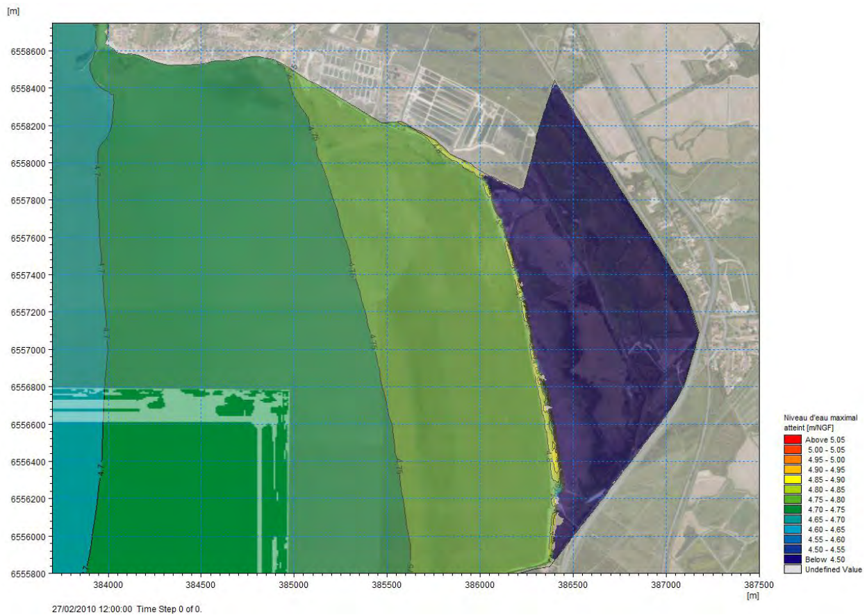
Figure 43 : niveaux d'eau maximums pour topographie existante
