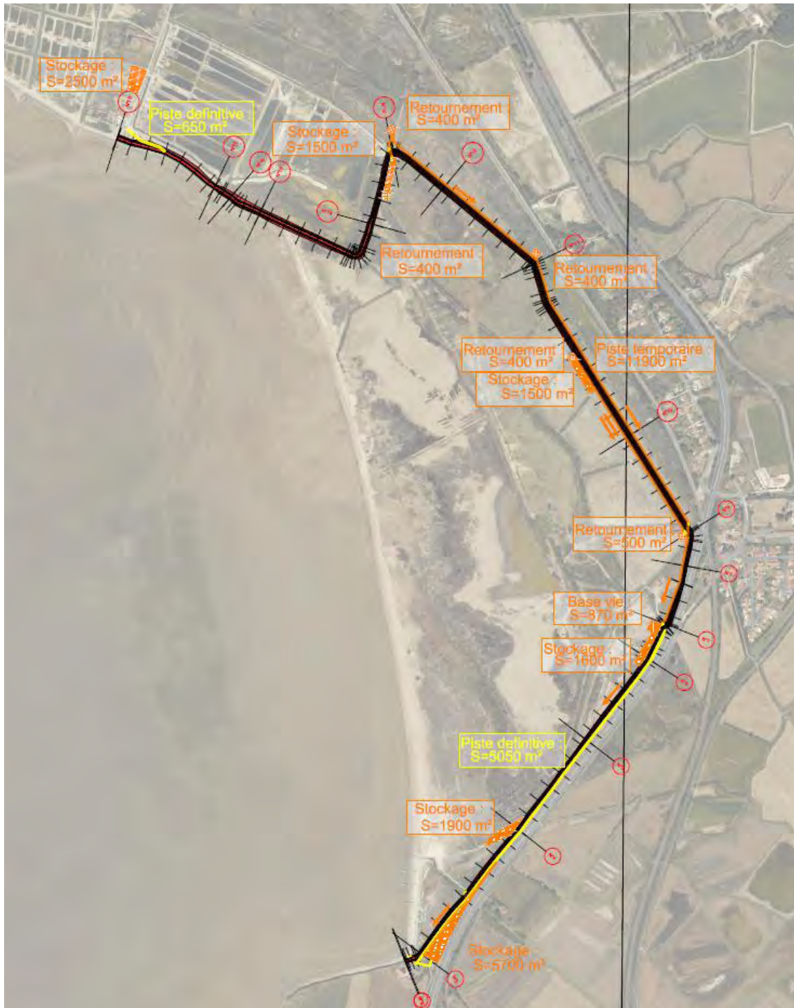
Figure 75 : Localisation des installations de chantier, pistes d'accès, zones de stockage et retournement en phase chantier
