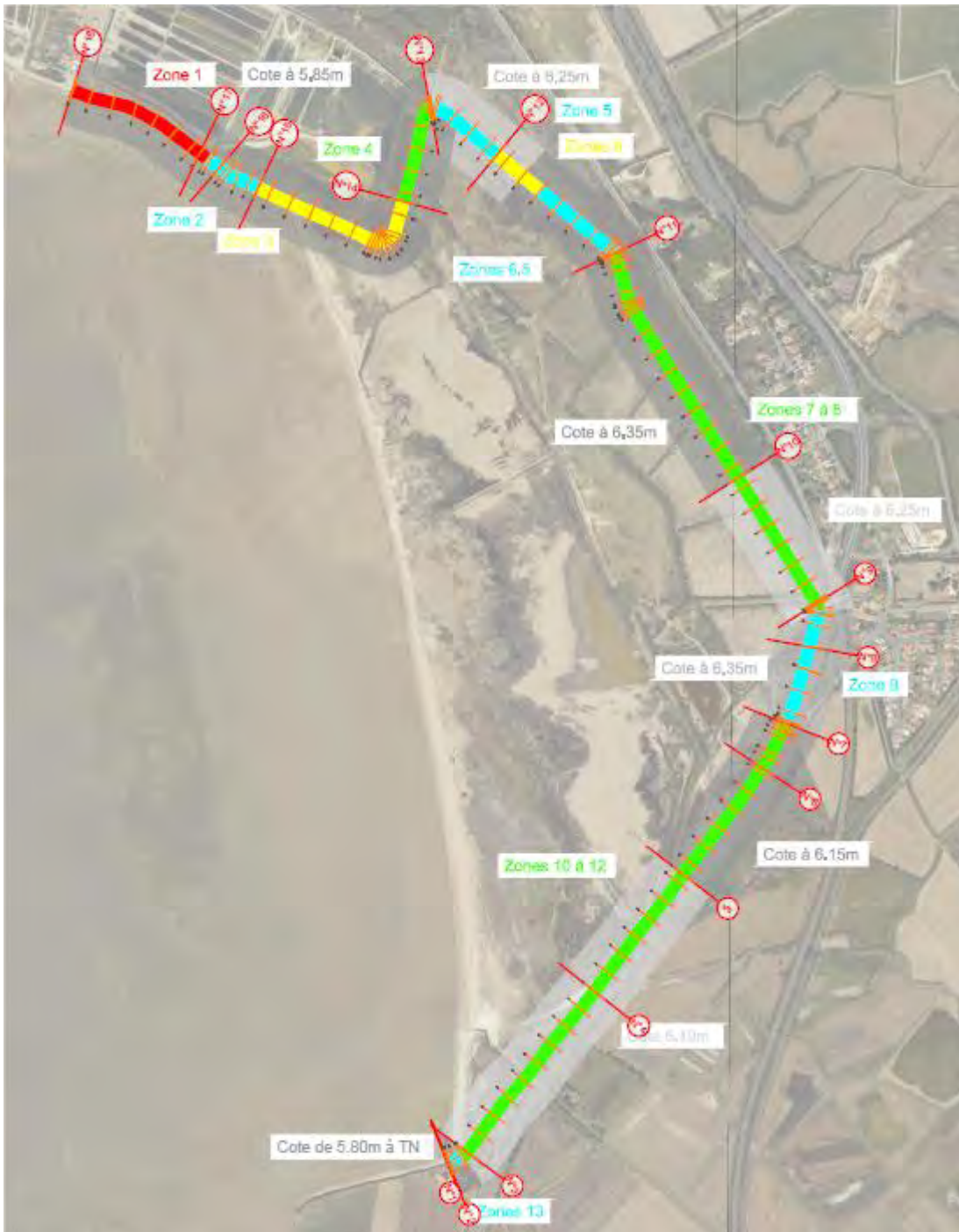
Figure 51 : Optimisation des cotes projet (sectorisation) au niveau du scenario de digue retenu
