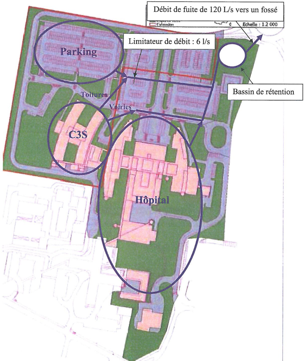
Figure 4- Synoptique du réseau pluvial existant
