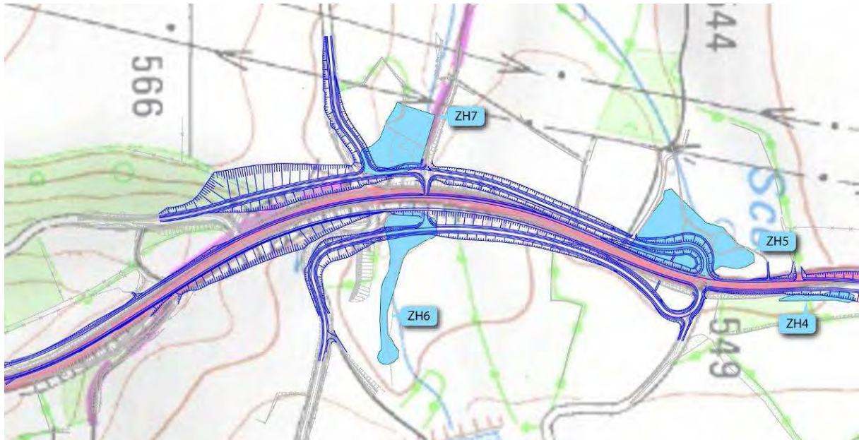
Figure 8 : Le tracé finalement retenu intercepte beaucoup moins la zone humide n°7 et ne l'enclave plus
