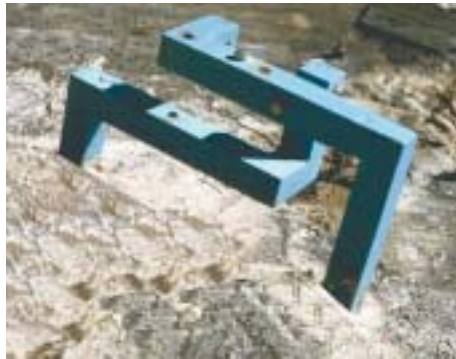
Photo 9. Vinchon sur une fissure pour la mesure de l'espace relatif entre deux plots.
