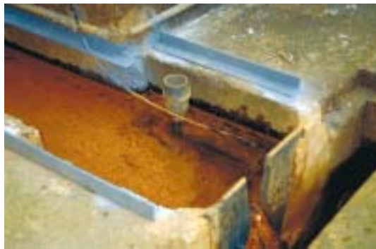
Photo 4b. Dispositif de mesure automatique télétransmise d'un débit de fossé de drainage, seuil triangulaire et capteur à ultrasons (le Gouet, Côtes d'Armor).
