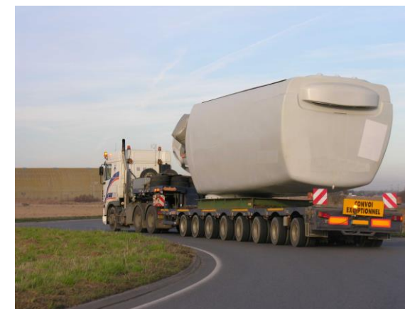
Transport de la nacelle
