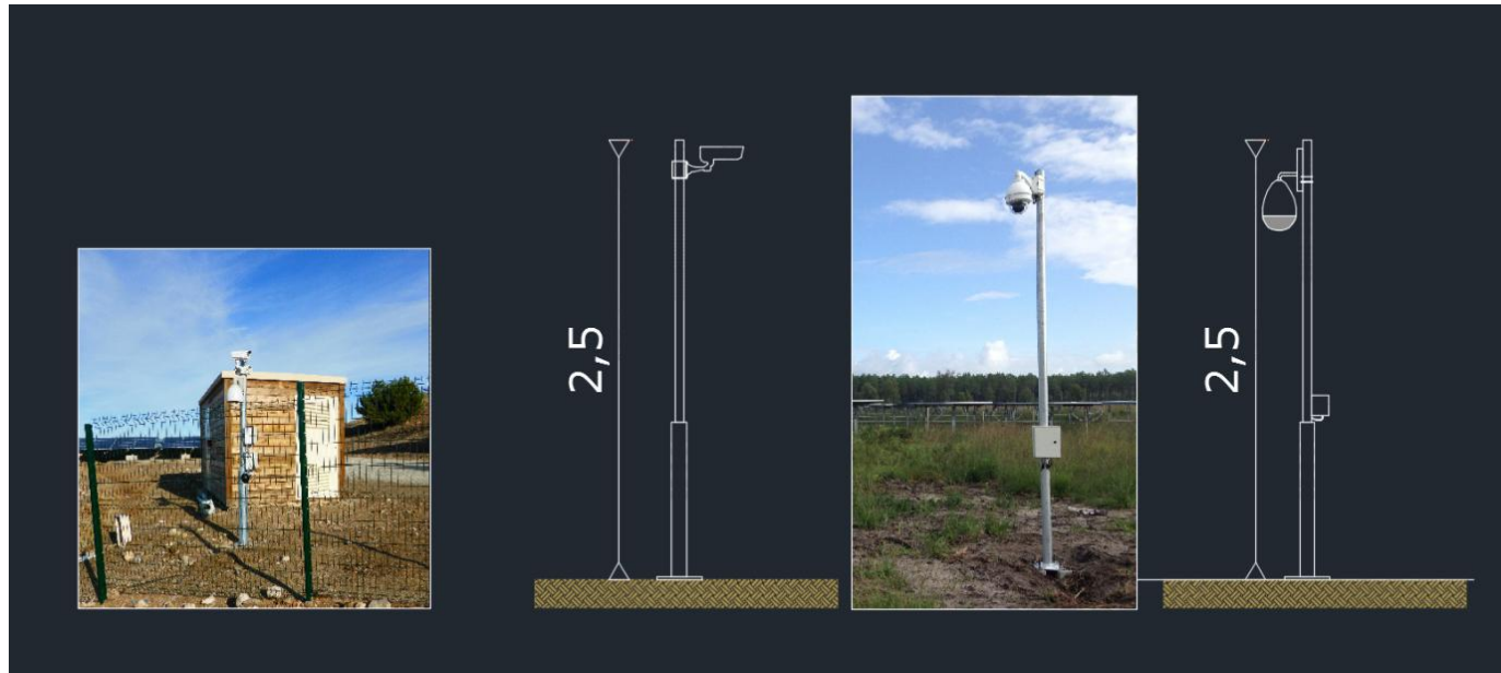
Fig. 13. Caméra de surveillance « fixe » ou « dôme »
