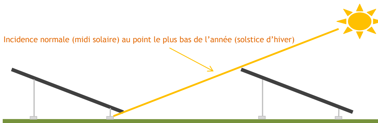
Fig. 6. Espacement des rangées en fonction du soleil
