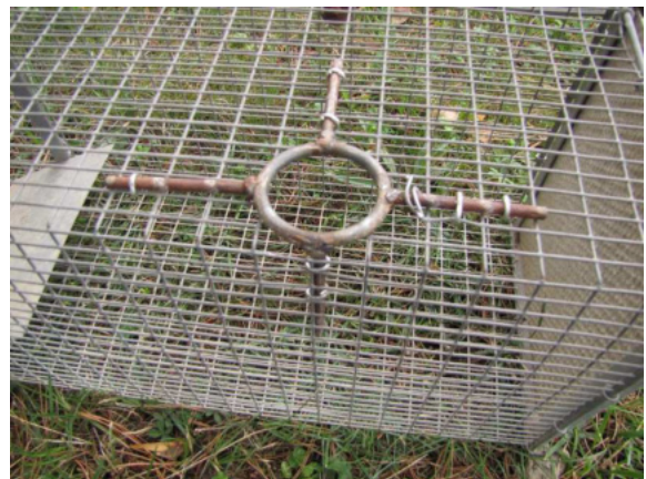
Figure 1 : dispositif testé : ouverture de 5 cm, renforcée par un anneau située sur le dessus de la cage-piège
