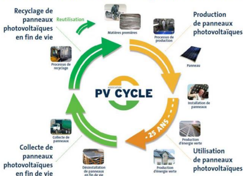
Figure 3 : Cycle de vie des panneaux photovoltaïques en silicium cristallin (source : PV CYCLE)
