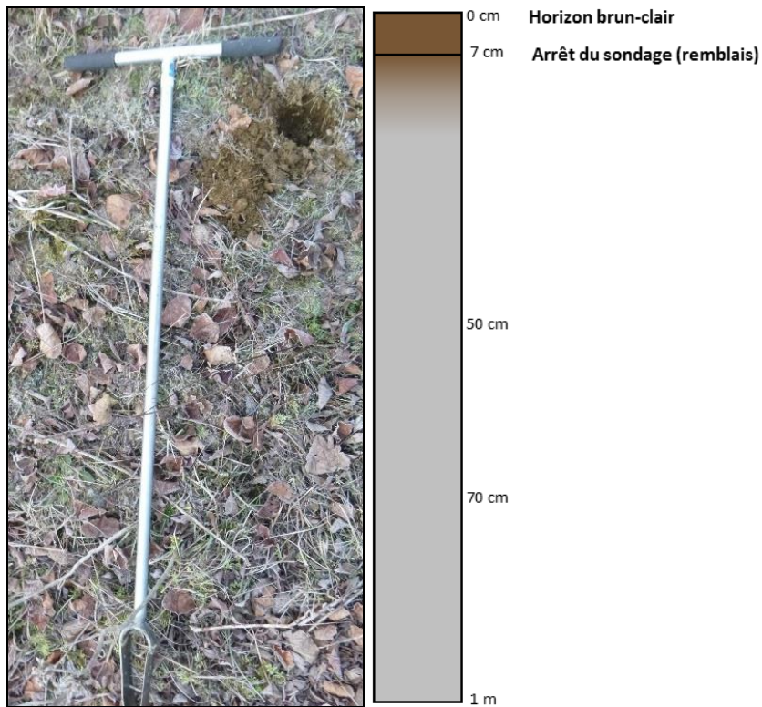
Figure 9 : Profil du sondage n°1
