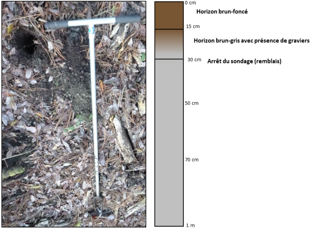
Figure 11 : Profil du sondage n°3
