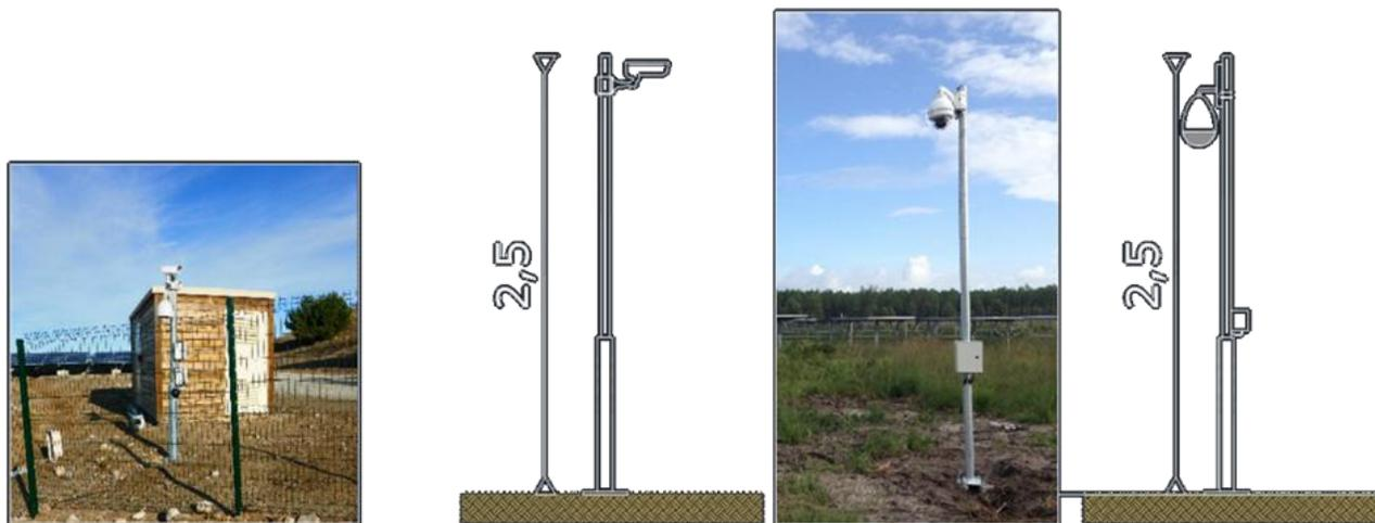
**Fig. 10. Caméra de surveillance « fixe » ou « dôme »**
