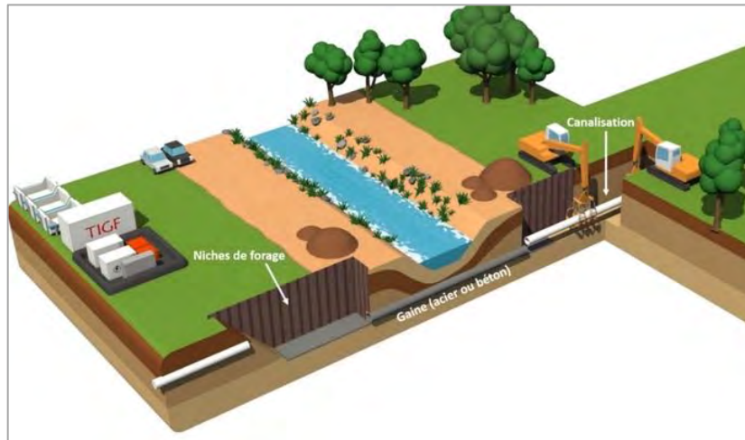
Figure 11 : Schéma de principe de mise en place d'un franchissement par fonçage ou forage droit
