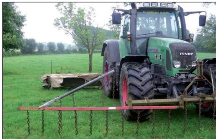
Figure 45 : Barre d'effarouchement implantée sur un engin mécanique
