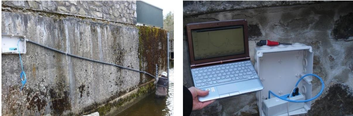
Figure 2 : Capteur de niveau d'eau de la station sortie Lac (à droite) / déchargement de l'enregistreur (à gauche)
