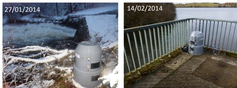
Figure 7 : Préleveurs automatiques déployés sur alerte débit durant l'hiver 2014.
