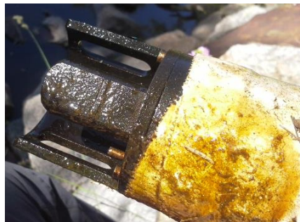
Figure 7 : Photographie d'un capteur de turbidité encrassé (Source : ATHOS Environnement)
