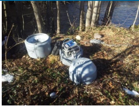
Figure 11 : Préleveur automatique déployé sur alerte débit durant l'hiver 2014-2015 (Source : ATHOS Environnement)
