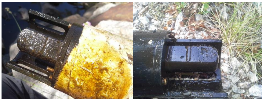
Figure 8 : Photographies de capteurs de turbidité encrassés (Source : ATHOS Environnement)
