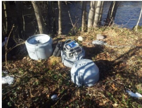
Figure 12 : Préleveur automatique déployé sur alerte débit durant l'hiver 2014-2015 (Source : ATHOS Environnement)
