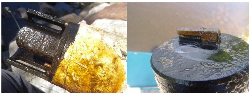
Figure 9 : Photographies de capteurs de turbidité encrassés, Aquatec à gauche et Solitax à droite (Source : ATHOS Environnement)
