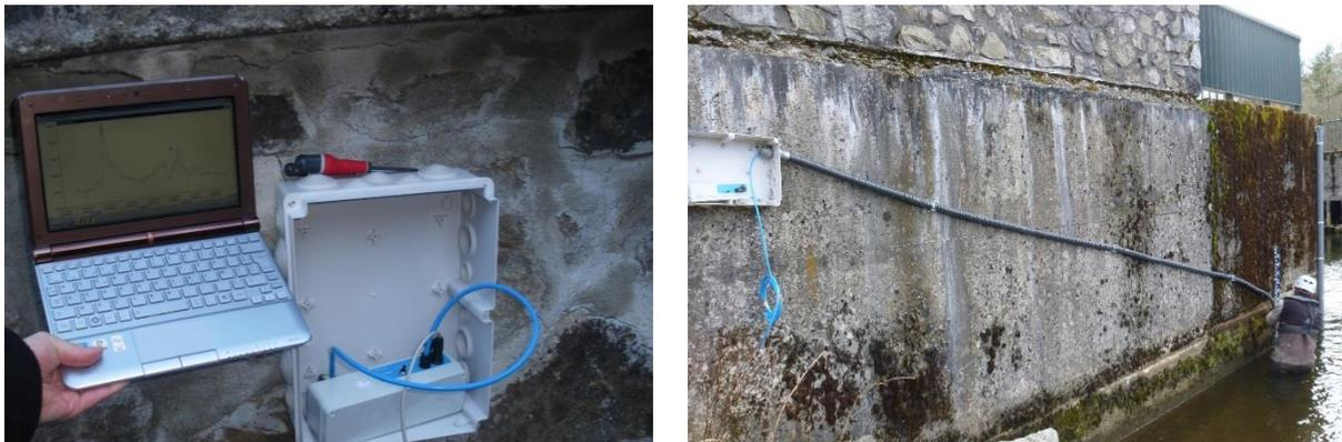
Figure 3 : Capteur de niveau d'eau de la station sortie Lac (à droite) / déchargement de l'enregistreur (à gauche) (Source : ATHOS Environnement)
