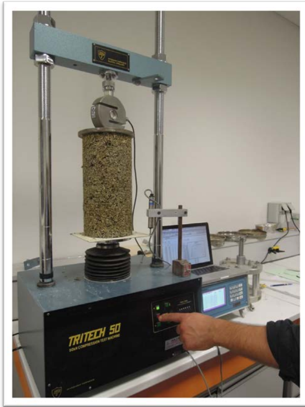
Essai mécanique de compression sur éprouvette de béton de chanvre
