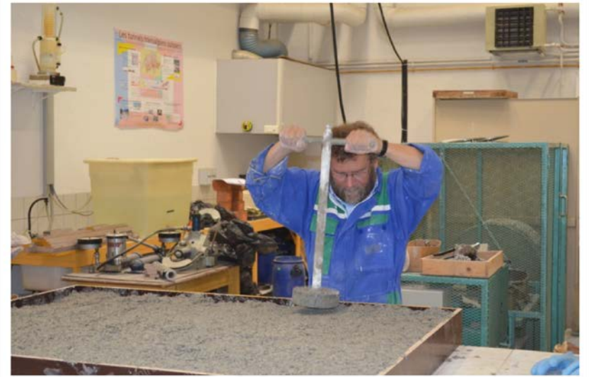
Tassage des échantillons pour les essais de réaction au feu
