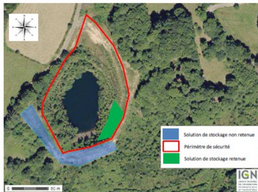
Figure 14 : Proposition de localisation de la zone de remblai des stériles miniers
