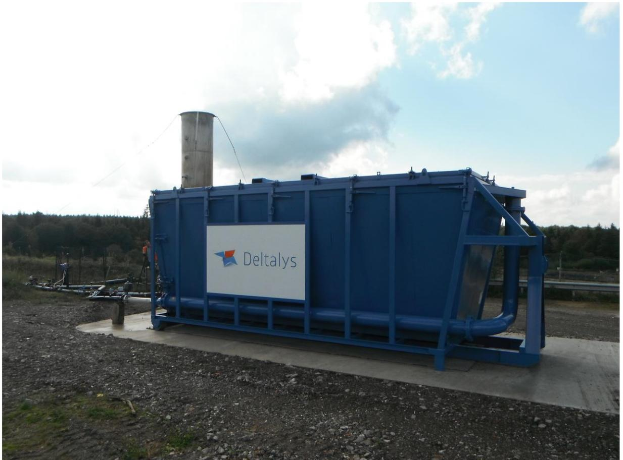
Quelques améliorations relatives au dimensionnement restent en cours d'étude. Cependant les résultats témoignent d'un abattement substantiel de la concentration en dioxyde de soufre après combustion du biogaz.
