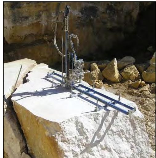
Sciage vertical au fil diamanté sur la carrière des Grippes. Juillet 2013
