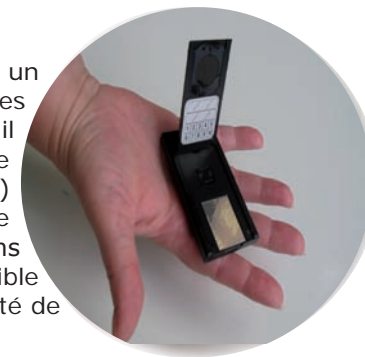
Exemple d'un détecteur : un dosimètre dit « ouvert »
