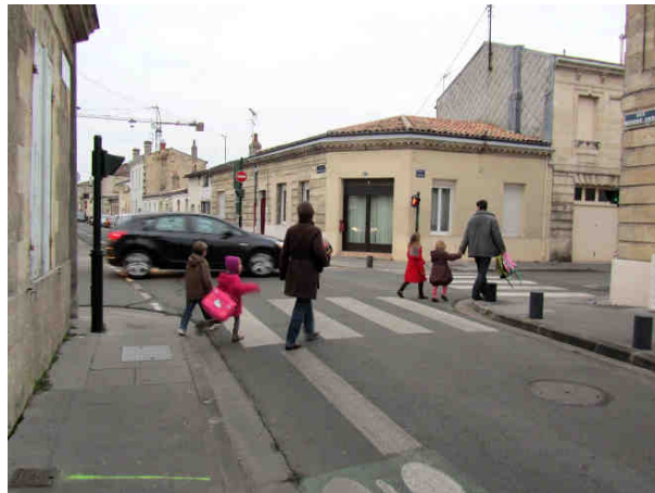
4- Changement de trottoir, traversée sécurisée aux passages piétons, mais petits plots dangereux sur le cheminement
