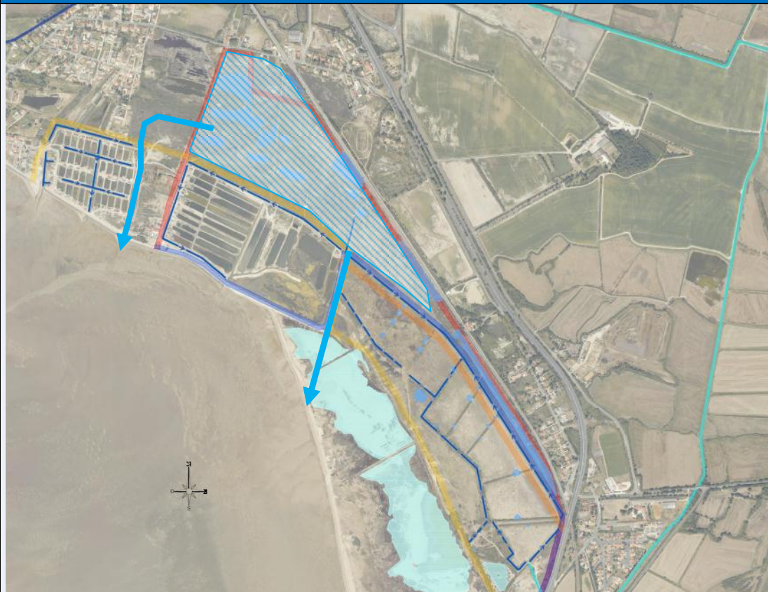
Localisation de la zone à ressuyer des « sablières » (rayée bleue) et localisation des deux exutoires directs à étudier (flèches bleues)
