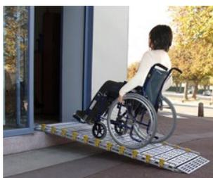
Une rampe devra respecter des caractéristiques techniques comme par exemple : Poids minimal de 300kg / Respecter les valeurs de pente présentées ci-dessus / présence de chasse-roues / largeur suffisante pour accueillir une personne en fauteuil roulant (dimension d'un fauteuil 0,75m X 1,25m) / non glissant / couleur mate, opaque, contrastée / dispositif de signalement.
