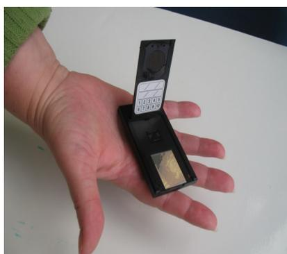
Exemple d'un détecteur : un dosimètre dit « ouvert »
