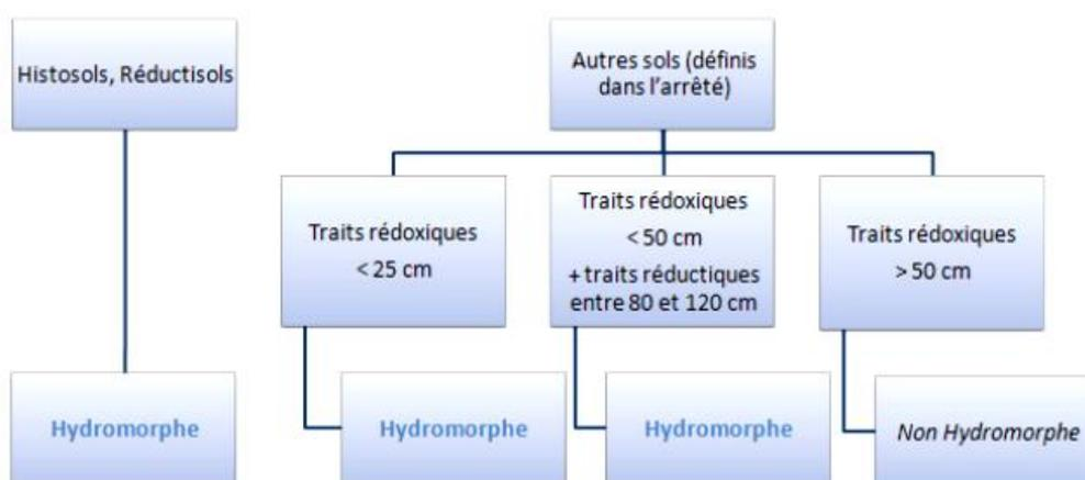
**Principe de détermination d'un sol hydromorphe de zone humide selon la réglementation.**
