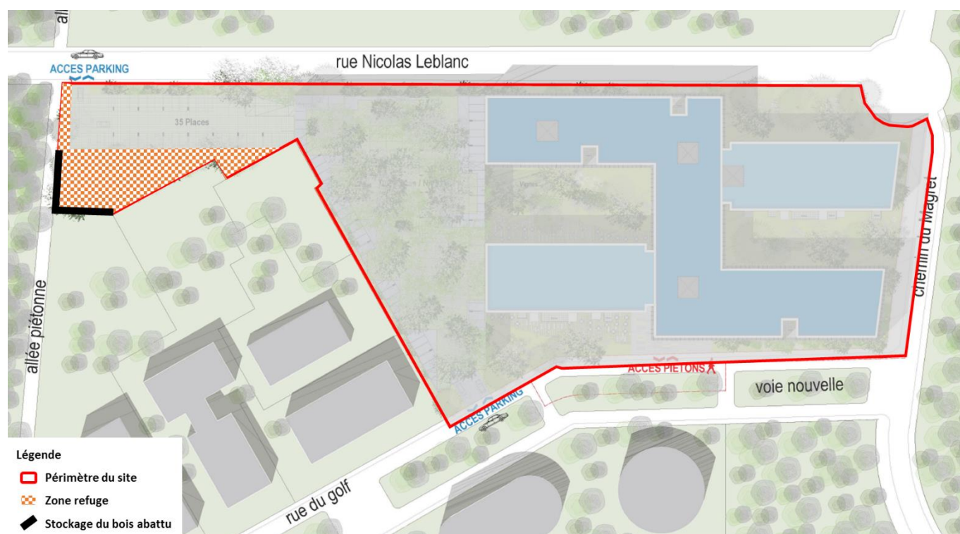
Fig. 104 Localisation du stockage du bois abattu provenant des opérations d'abattage de la phase chantier.
