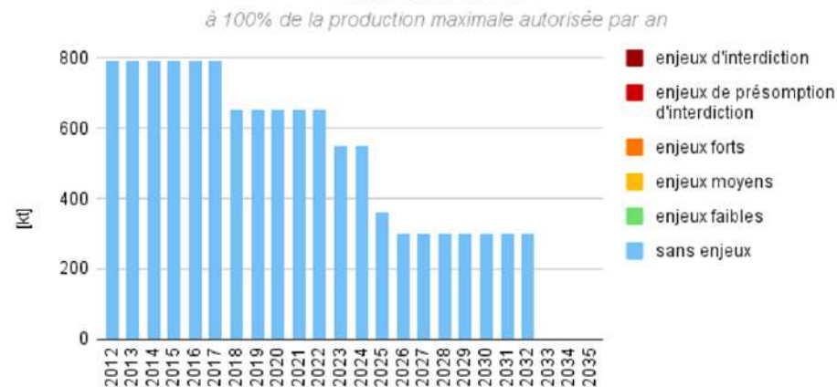
Evolution de la production en granulats alluvionnaires du bassin de production Lit majeur Lot 47, sans renouvellement d'autorisations, en fonction des zones à enjeux environnementaux
