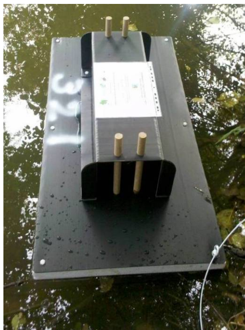
Figure 6 : Exemple d'un radeau à empreintes pour détecter le Vison d'Amérique
