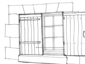
Fenêtre courante : rectangulaire, volets battants bien ajustés, équerre extérieure au nu du bois. Vient s'ajuster à l'intérieur du cadre.
