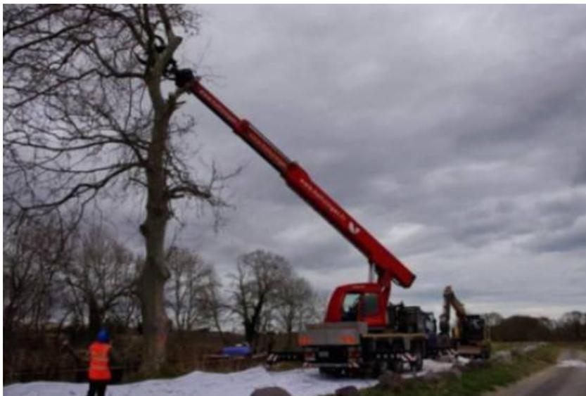
**Fig. 29.** Découpe du houppier à l'aide d'un grappin hydraulique (Source : Naturalia - Canal du Midi)
