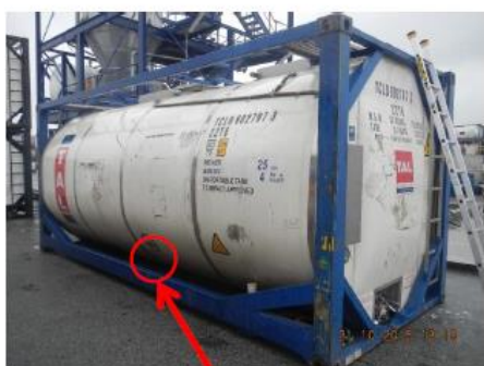
Zone de la fuite
