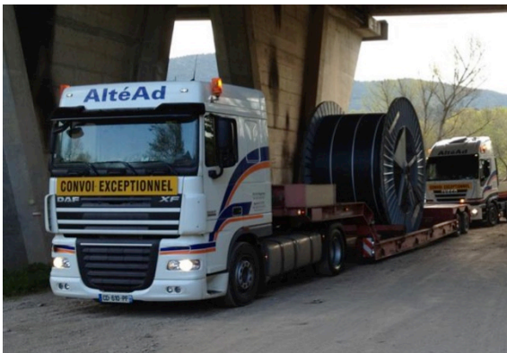
Transport des tourets par semi-remorque
