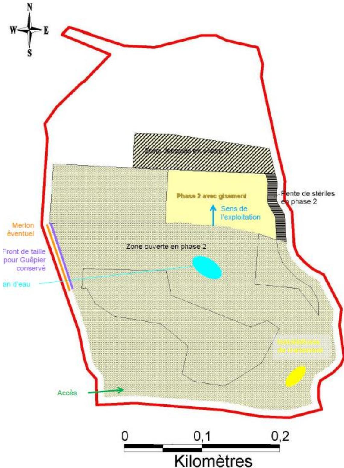
Figure 9: Plan de phasage d'exploitation simplifié - Phase 2
