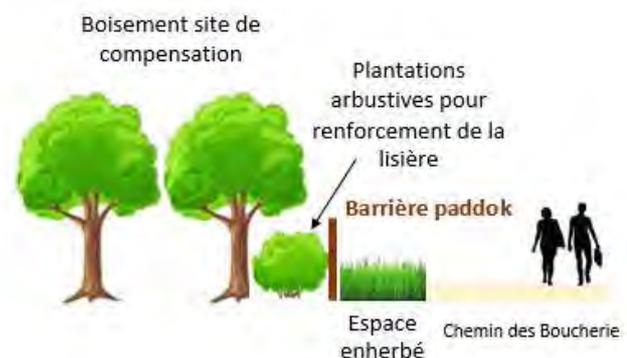
Figure 55 : Schéma de principe du traitement de la lisière nord et est du site
