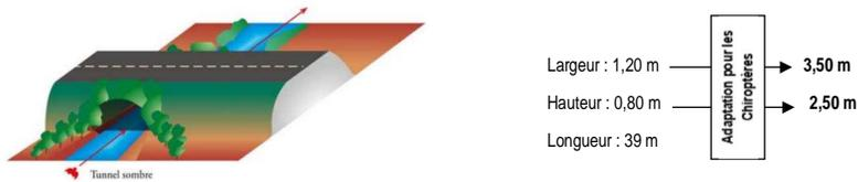
Schema de principe de passage inférieur - (© Limpens et al., 2005)
