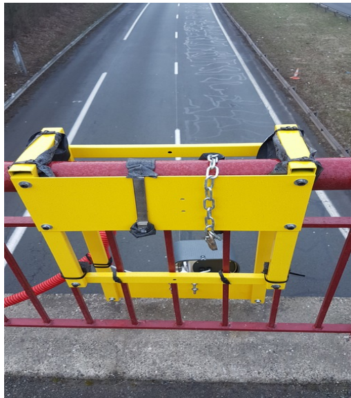
Illustration 3: Dispositif d'accroche d'une caméra - Campagne de Lille
