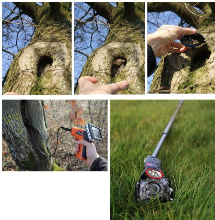
Figure 30. En haut : Cavité favorable, vérification des recoins à l'aide de miroirs ou de lampe. En bas à gauche : vérification d'une cavité à l'aide d'une caméra endoscopique En bas à droite : caméra miniature équipée sur une perche télescopique de 7 mètres pour les cavités en hauteur
