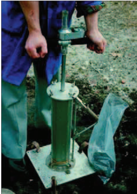
▲ 4 - Contrôle de compactage au densitomètre à membrane...
