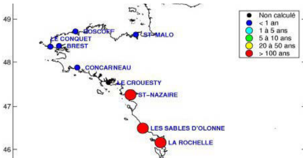
Estimation des périodes de retour des hauteurs de pleine mer observées lors du passage de Xynthia, (source SHOM)
