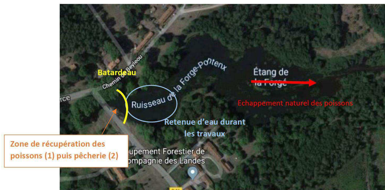
Figure 52 : Schéma du chantier de sauvetage FD40 (images ©2019 Google)
