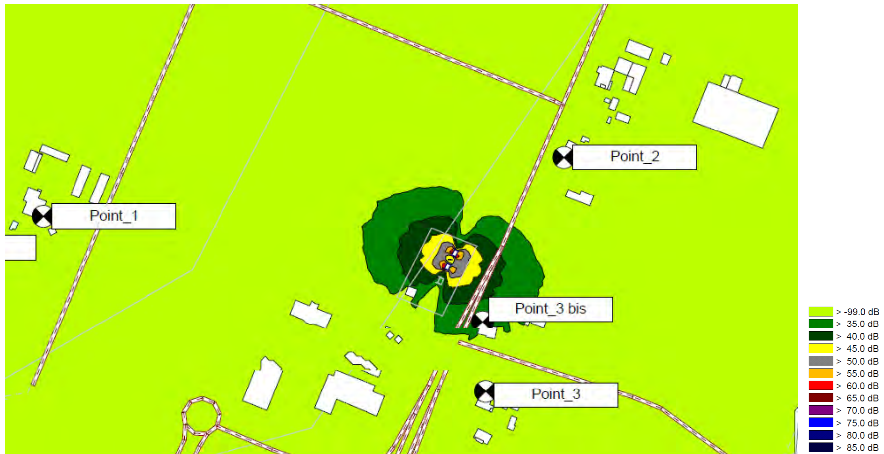
Cartographie sonore du scénario 2 – fonctionnement simultané des transformateurs 1 et 2 et échelle du niveau sonore en dBA
