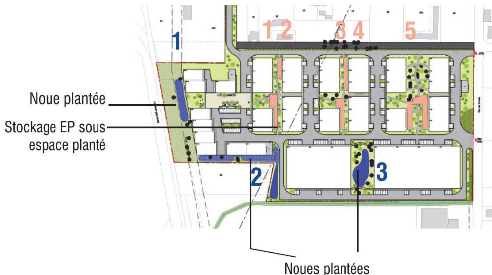
Localisation des ouvrages de régulation des EP
