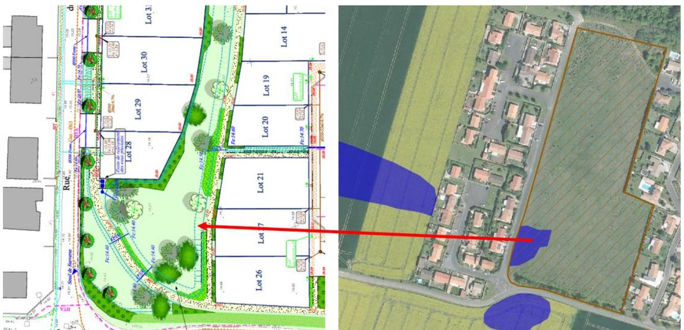
Figure 9. Positionnement du bassin de rétention des eaux pluviales
