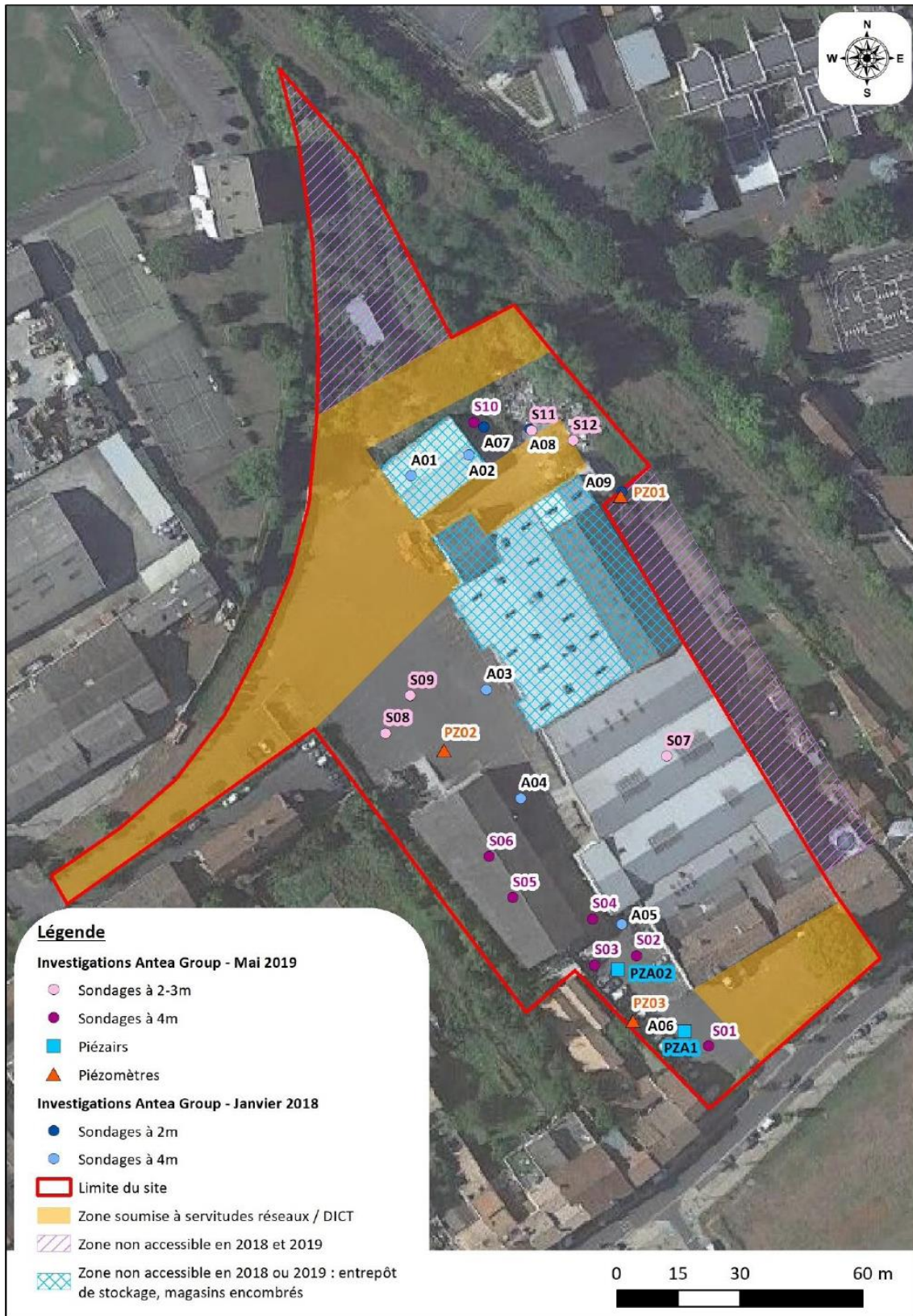
Plan de localisation des investigations réalisées par ANTEA GROUP en janvier 2018 et mai 2019 (source : ANTEA GROUP)
