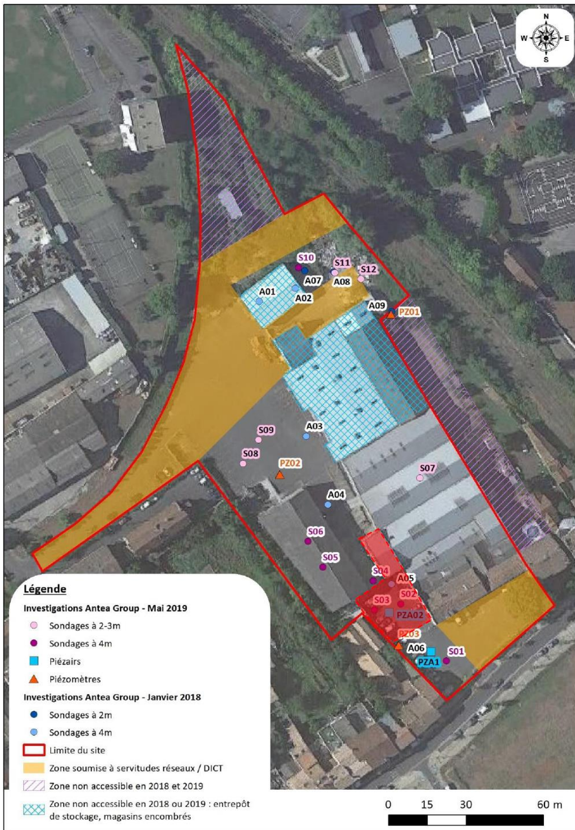
Plan de localisation de la zone de contamination en hydrocarbures identifiée par ANTEA GROUP (source : ANTEA GROUP)
